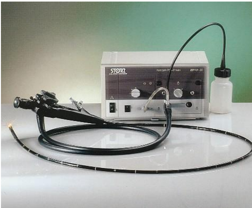
Figura 1. Endoscopio Flexible: Se observa la cabeza de mando con posibilidades de deflexión de la punta arriba, abajo, izquierda y derecha. El canal de trabajo
